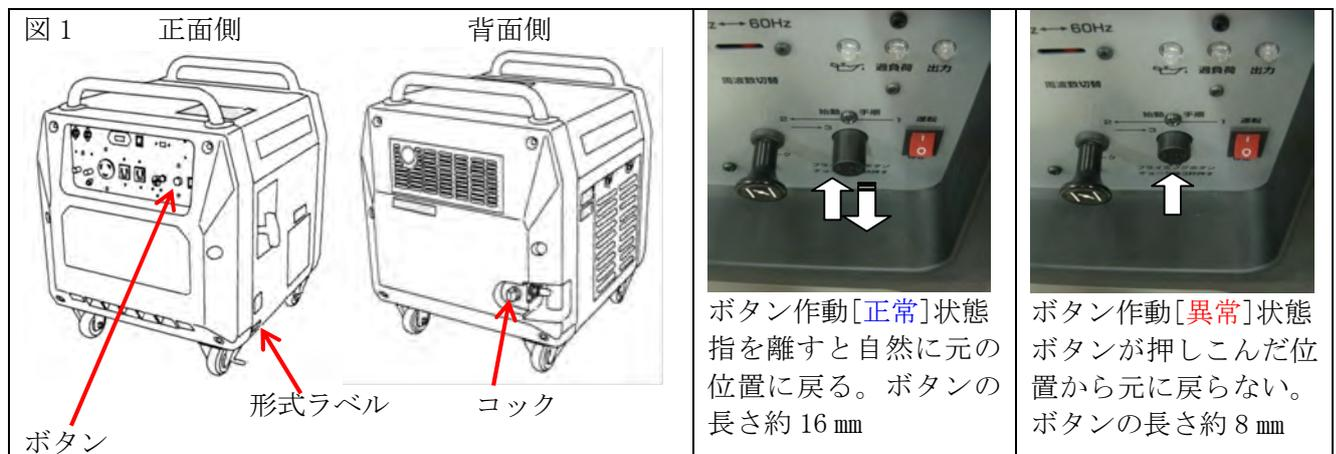
※ボタンの機能： LP ガス用レギュレータには、エンジン停止時、自動的にガスの通路を遮断する安全弁の機能(バキュームロック)があります。エンジン始動時にボタンで安全弁を一時的に解除し、エンジン側にガスを供給します。
