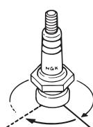
8. スパークプラグを取り付け、規定のトルクで締め付けます。
