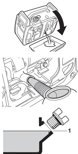
6. 発電機本体を傾けてエンジンオイルを抜きます。
