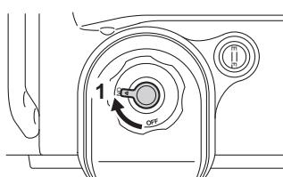
1. 周波数切替スイッチを使用する電気器具の周波数に合わせます。
