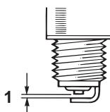
5. スパークプラグの焼け具合を点検します。通常はキツネ色に焼けますが、黒くくすぶっていたり白く焼けていたときはエアクリーナを点検します。
