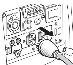
1. 電気器具のスイッチを OFF (切) にします。
