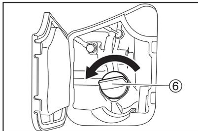
10. 新しいエンジンオイルを規定量（注入口の口元まで）給油します。
