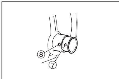
6. マフラーワイヤネットとマフラーキャップを取り付け、マフラーキャップボルトを規定のトルクで締め付けます。
