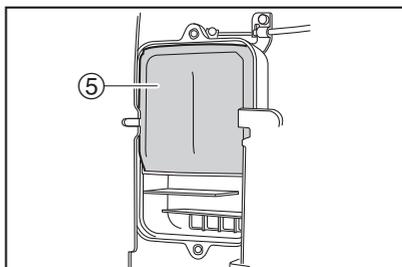
8. エアクリーナカバーを元の位置に戻し、スクリュを締め付けます。
