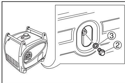
6. 新しいガスケット③とエンジンオイルドレンボルト②を取り付け、エンジンオイルドレンボルトを規定のトルクで締め付けます。
