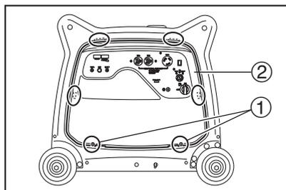
3. エアクリーナカバー①を固定しているスクリュー②を外します。
