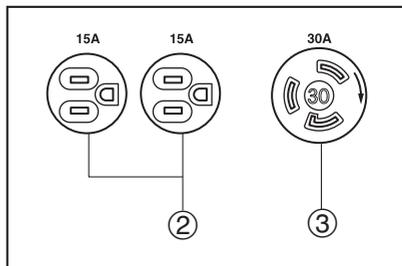
交流コンセント②には単相 100V で合計消費電流 15A 以下の電気器具のプラグを差し込みます。
