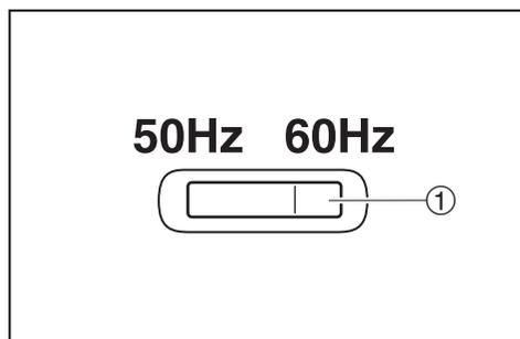
60Hz仕様の電気器具を接続するときは、周波数切替スイッチの60Hz側①を押してください。
