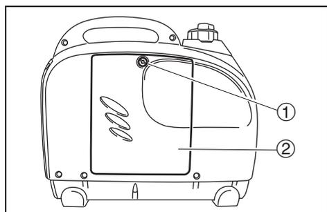
3. エアクリーナカバー①を固定しているクリップ②を外します。
