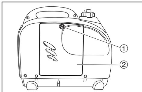
9. キャブレタのドレンスクリュー①を⊕ドライバで弛めて燃料を抜きます。
