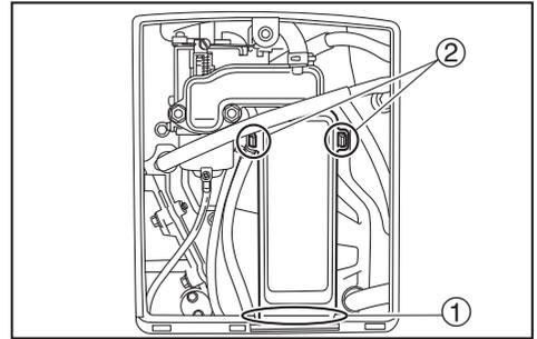
10. カバー①を取り付けて、ボルト②を締め付けます。
